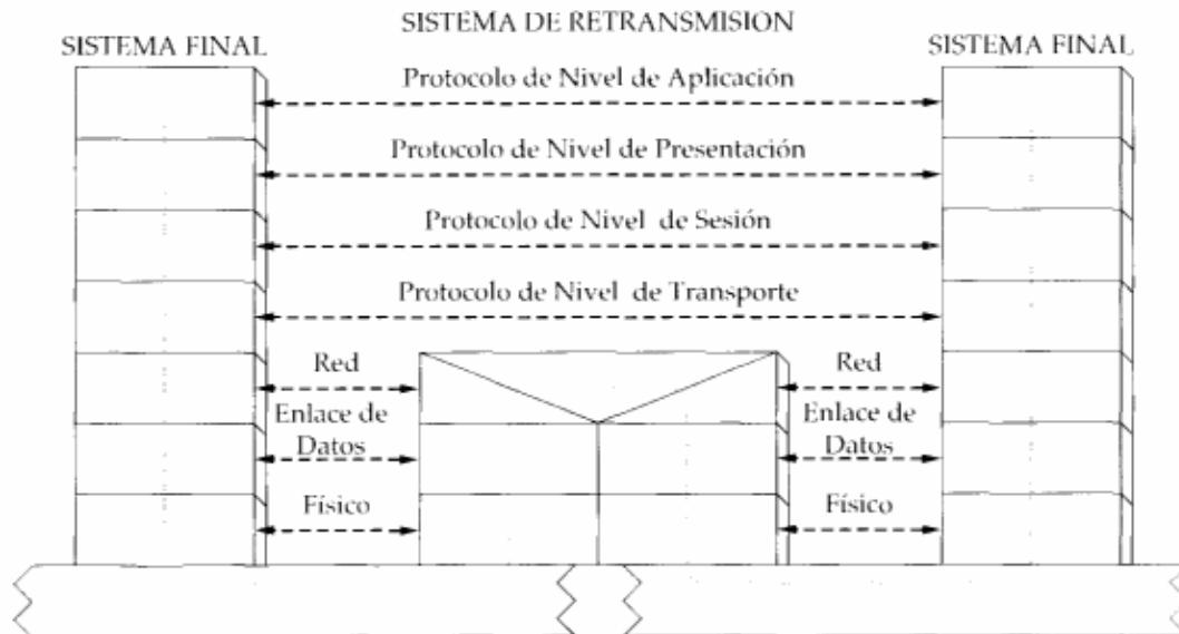
FIGURA 12.9 Utilización de un esquema de retransmisión
