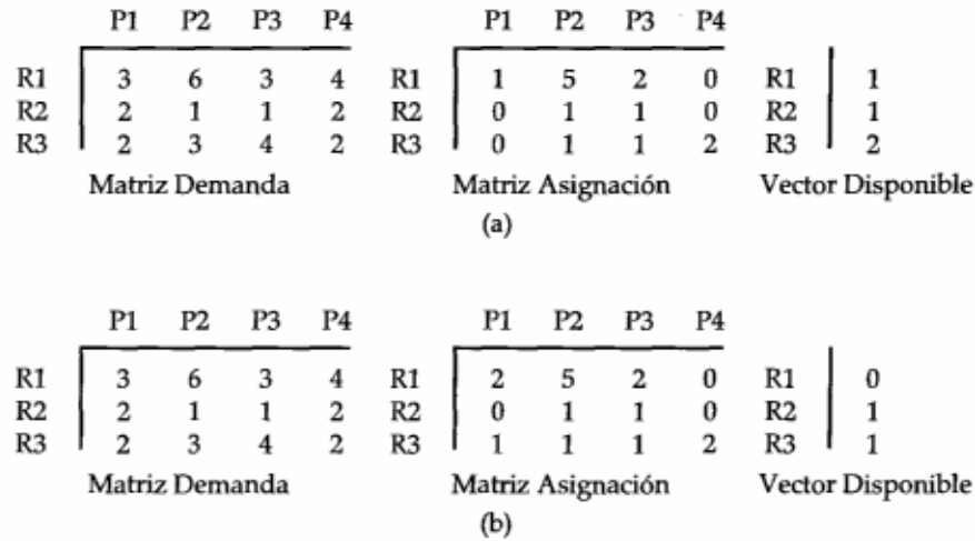
FIGURA 5.4 Determinación de un estado inseguro
