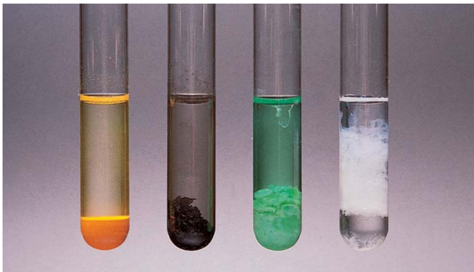
Figura 4.4 Aparición de algunos precipitados. De izquierda a derecha: CdS, PbS, Ni(OH) 2 y Al(OH) 3 .
