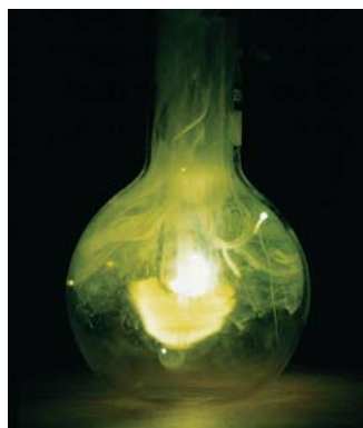
Reacción del sodio metálico con el cloro gaseoso para formar el cloruro de sodio.
