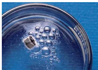
El litio reacciona con agua para producir hidrógeno gaseoso.
