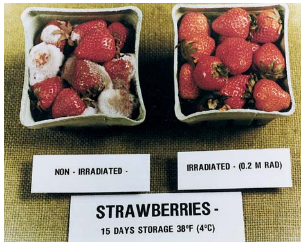
Las fresas irradiadas a 200 kilorrads (derecha) siguen frescas después de 15 días de almacenamiento a 4°C; las que no se irradiaron se enmohecieron.
