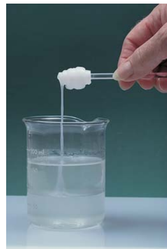
Figura 25.7 El truco de la cuerda de nailon. La adición de una disolución de cloruro de adipóilo (un derivado del ácido adípico en el cual los grupos OH se han reemplazado por grupos Cl) en ciclohexano a una disolución acuosa de hexametildiamina provoca que el nailon se forme en la interfase entre ambas disoluciones, las cuales no se mezclan. De esta manera, se puede extraer el nailon.
