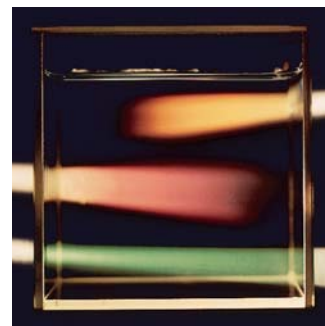
Figura 12.15 Tres rayos de luz blanca que atraviesan un coloide de partículas de azufre en agua cambian a naranja, rosado y verde azulado. Los colores que se producen dependen del tamaño de las partículas y también de la posición del observador. Cuanto menor el tamaño de las partículas dispersas, menor será la longitud de onda (y más azul).
