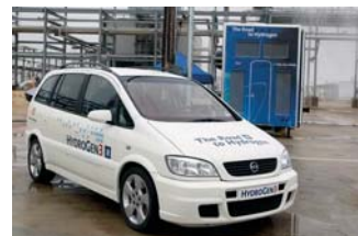
Automóvil fabricado por General Motors que se impulsa por celdas de combustible de hidrógeno.
