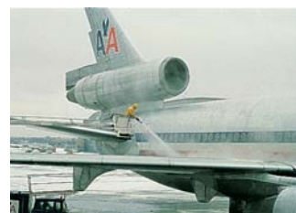
El tratamiento antihielo para los aviones está basado en la disminución del punto de congelación.
