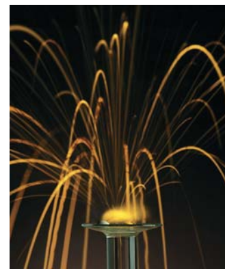
El sodio reacciona con agua para formar hidrógeno gaseoso.
