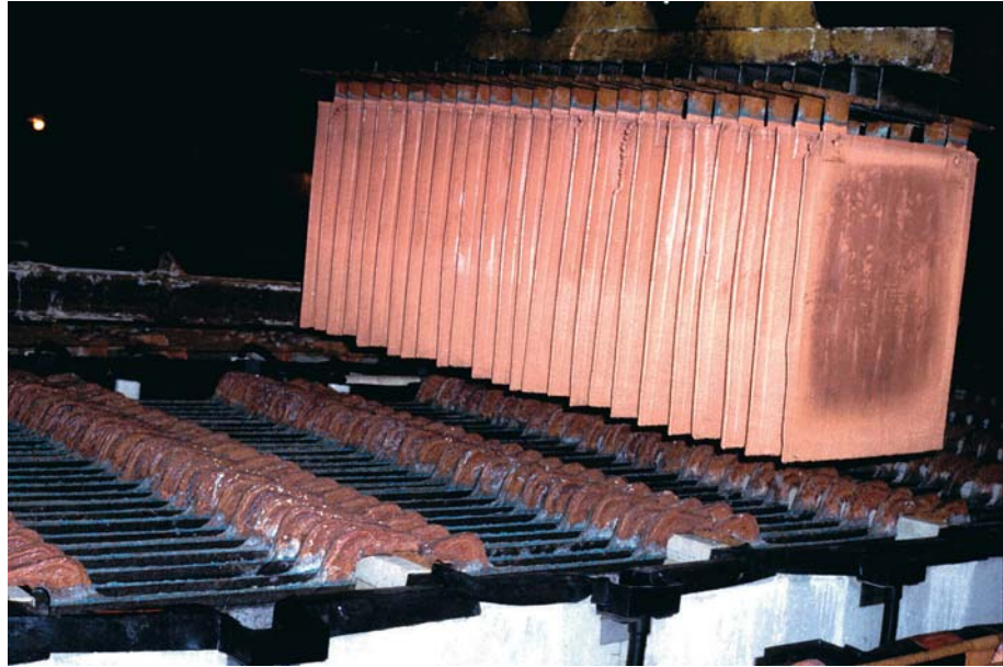
Figura 21.7 Cátodos de cobre utilizados en el proceso de electrorrefinación.
