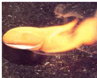
El fósforo blanco se quema en el aire para formar \text{P}_4\text{O}_{10} .
