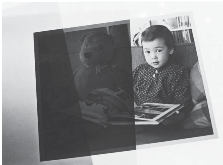
Figura 23.15 Con una lámina Polaroid sobre una foto, la luz pasa a través de ella. Con una segunda lámina de Polaroid colocada sobre la primera de manera que los ejes de polarización de las láminas sean perpendiculares, muy poca o nada de luz las atraviesa. Si los ejes de polarización de ambas láminas fueran paralelos, la luz las atravesaría.
