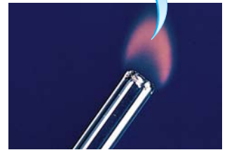
Combustión del hidrógeno en el aire para formar agua.
