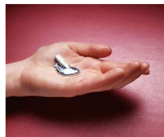
El galio se funde en la mano de una persona (la temperatura corporal es de aproximadamente 37°C).
