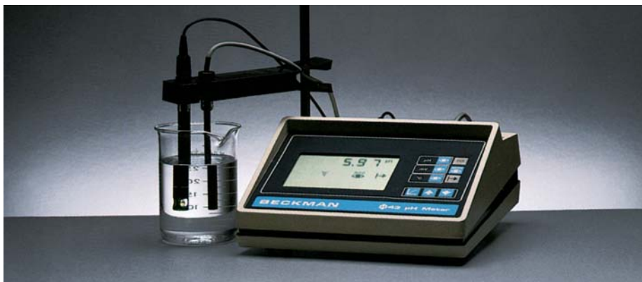
Figura 15.2 Un medidor del pH se utiliza comúnmente en el laboratorio para determinar el pH de una disolución. A pesar de que muchos medidores del pH tienen escalas marcadas con valores que van de 1 a 14, los valores del pH, de hecho, pueden ser menores a 1 y mayores que 14.
