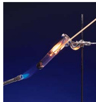
El calentamiento del clorato de potasio produce oxígeno, el cual es responsable de la combustión de la tablilla de madera.
