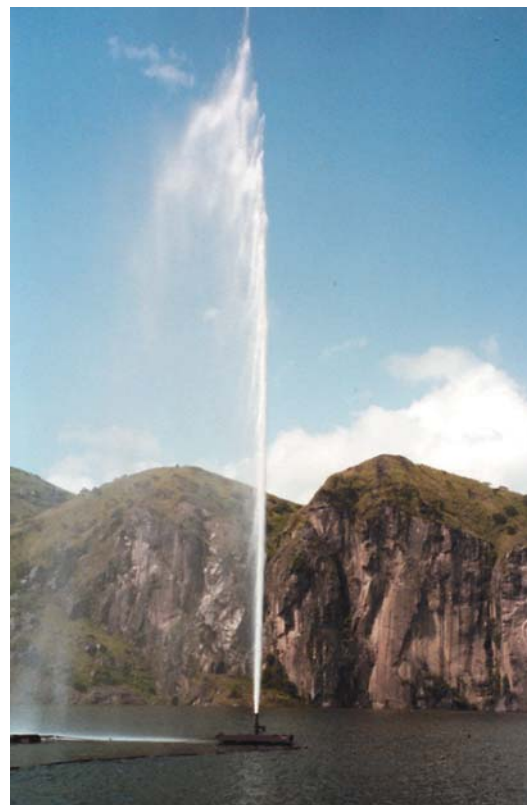
Las aguas profundas del lago Nyos se bombean hacia la superficie para extraer el \text{CO}_2 gaseoso disuelto.
