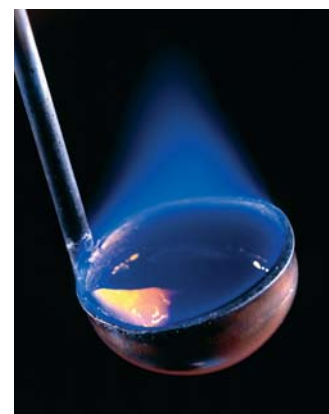
Azufre que se quema en el aire para formar \text{SO}_2 .
