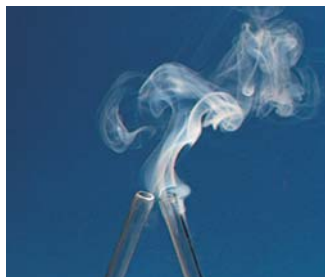
Figura 15.11 Reacción ácido-base de Lewis entre el \text{BF}_3 y el \text{NH}_3 .
