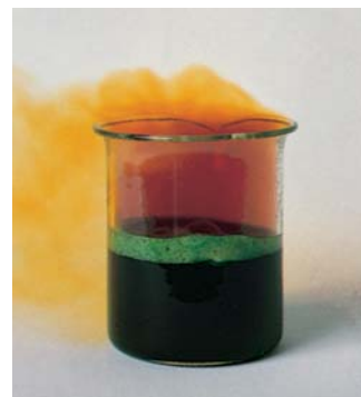
Figura 22.7 Producción de \text{NO}_2 gaseoso cuando el cobre reacciona con ácido nítrico concentrado.
