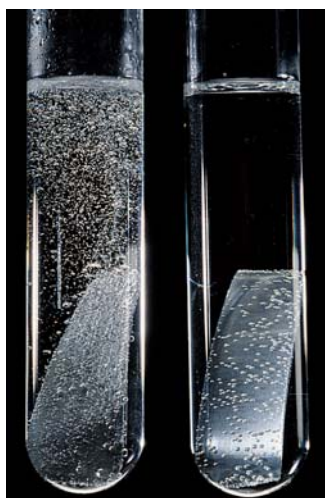
El Zn reacciona más vigorosamente con un ácido fuerte como el HCl (izquierda) que con un ácido débil como el \text{CH}_3\text{COOH} (derecha) de la misma concentración debido a que hay más iones \text{H}^+ en la primera disolución.
