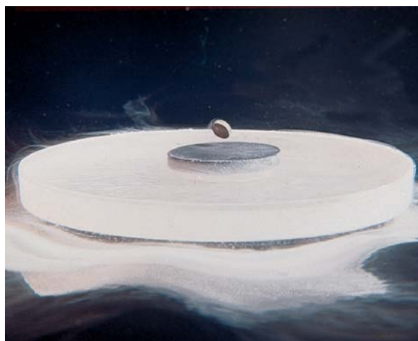
Levitación de un imán por encima de un superconductor a altas temperaturas inmerso en nitrógeno líquido.
