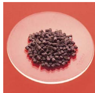
Catalizador de platino en alúmina (Al 2 O 3 ) que se utiliza en la hidrogenación.
