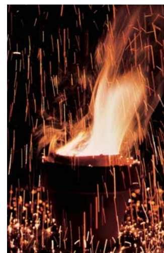
Figura 21.19 La temperatura de una reacción termita puede alcanzar casi 3\,000^\circ\text{C} .
