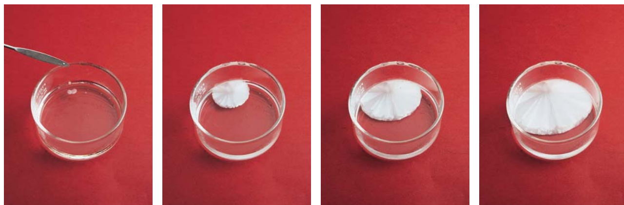
Figura 12.1 Cuando se siembra un pequeño cristal a una disolución sobresaturada de acetato de sodio (izquierda), se forman rápidamente cristales de acetato de sodio.
