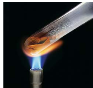
Al calentar el HgO se descompone para producir Hg y O 2 .
