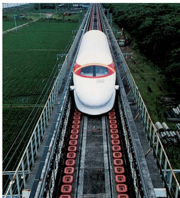
Tren experimental de levitación que opera sobre un material superconductor a la temperatura del helio líquido.
