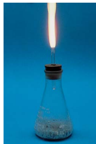
La reacción del carburo de calcio ( \text{CaC}_2 ) con agua produce acetileno ( \text{C}_2\text{H}_2 ), un gas inflamable.
