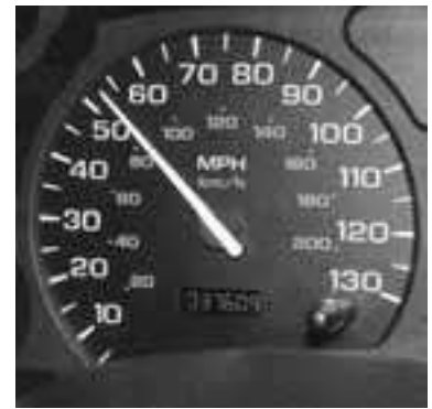
FIGURA 2-8 El velocímetro del auto muestra mi/h en números grandes y km/h en pequeños.
