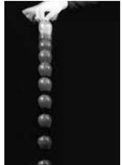
FIGURA 2-18 Fotografía estroboscópica de una manzana que cae, a iguales intervalos de tiempo. La manzana cae una distancia mayor durante cada intervalo sucesivo, lo que significa que está acelerando.
