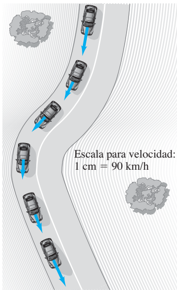
FIGURA 3-1 Un automóvil que viaja sobre una carretera. Las flechas azules representan el vector velocidad en cada posición.
