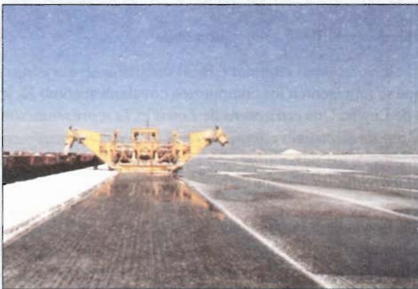
Obtención de cloruro de sodio por evaporación solar.
