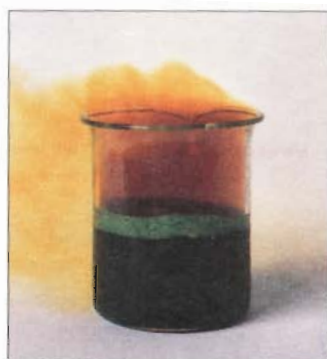
FIGURA 21.7 Producción de \text{NO}_2 gaseoso como resultado de la reacción de cobre con ácido nítrico concentrado.
