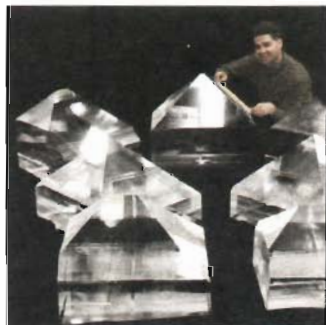
Estos cristales gigantes de dihidrógeno fosfato de potasio crecieron en el laboratorio. El más grande ¡pesa 701 libras!
