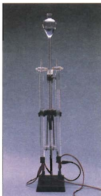
FIGURA 19.18 Aparato para la electrólisis de agua en pequeña escala. El volumen del hidrógeno gaseoso generado (columna izquierda) es el doble que el del oxígeno gaseoso (columna derecha).
