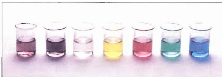
FIGURA 22.20 Colores de algunos iones en disolución de metales de transición de la primera serie. De izquierda a derecha: \text{Ti}^{3+} , \text{Cr}^{3+} , \text{Mn}^{2+} , \text{Fe}^{3+} , \text{Co}^{2+} , \text{Ni}^{2+} , \text{Cu}^{2+} . Los iones \text{Sc}^{3+} y \text{V}^{5+} son incoloros.
