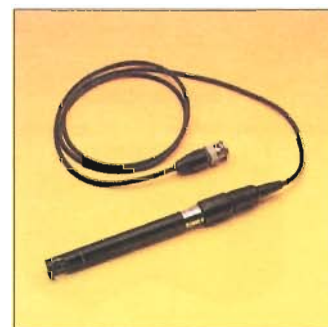
FIGURA 19.6 Un electrodo de vidrio que se emplea junto con un electrodo de referencia en un potenciómetro.
