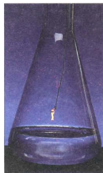
Un alambre caliente de platino resplandece cuando se mantiene sobre una disolución concentrada de amoníaco. La oxidación del amoníaco para producir óxido nítrico es catalizada por el platino y es altamente exotérmica.
