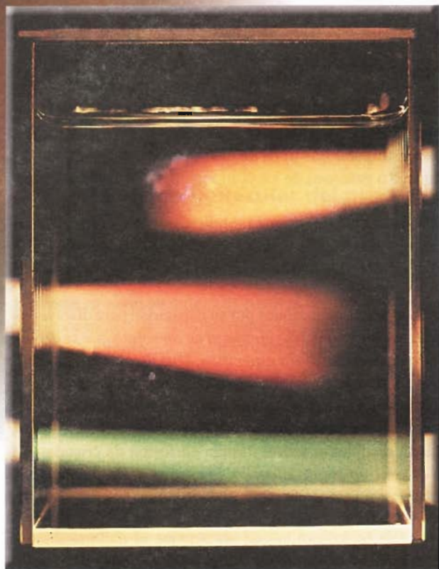
Tres rayos de luz blanca que pasan a través de un coloide de partículas de azufre en agua cambian a anaranjado, rosa y verde azulado.
