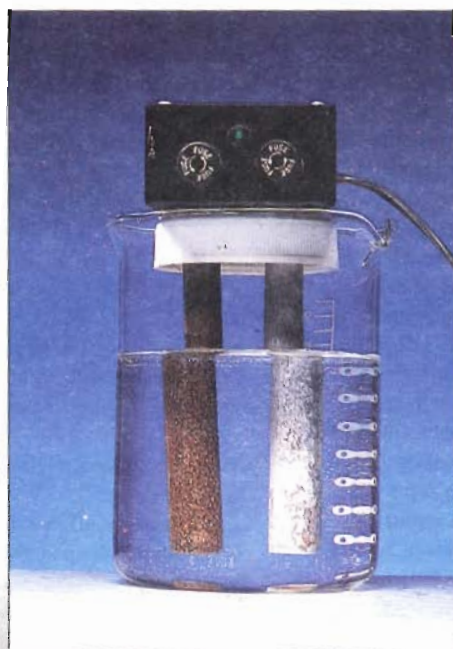
Precipitador con sus electrodos sumergidos en el agua. Izquierda: Antes de que inicie la electrólisis. Derecha: 15 minutos después de que la electrólisis empezó.
